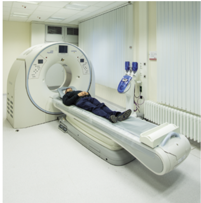
CT (320 Zeilen/640 Schichten mit Techniken zur Dosisreduktion)
